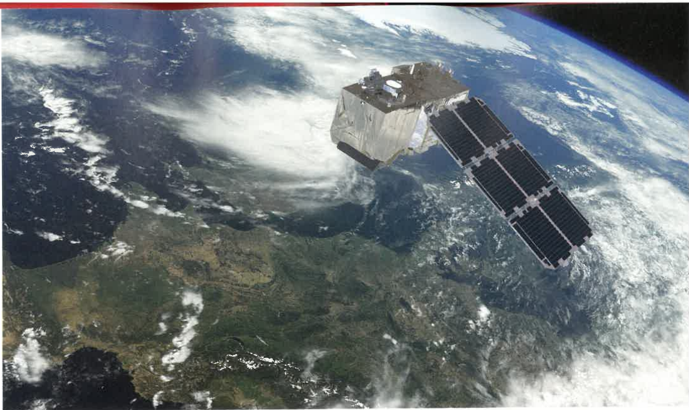
Der Sentinel-2 der ESA gehört zu den vier in jüngster Zeit auf eine Umlaufbahn gebrachten Erdbeobachtungssatelliten. Zur Ausstattung gehört eine hochauflösende Multispektralkamera. Die Daten stehen der Agrarbranche und Behörden kostenfrei zur Verfügung. Foto: ESA
