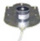
Sonneneinstrahlung Notwendig für die Berech- nung der Verdunstung. Hilfreich für die Messungen in der Landwirtschaft und Solarenergiegewinnung.
