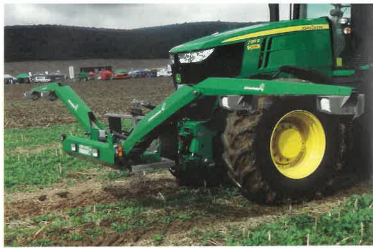
Eine beim GreenSeeker angebotene Option mit vier Sensorköpfen erhöht die repräsentative Messfläche.
