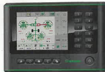
△ DS 100: eine einfache Bedieneinheit mit zwölf Funktionsknöpfen.
