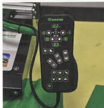
△ An dem Terminal lässt sich auch ein Joystick anschließen.
